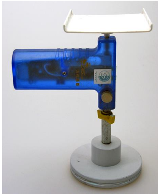
图 33 使用 DISLab 构造电子天平
