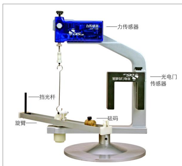
图 49 DISLab 向心力实验器的构成
