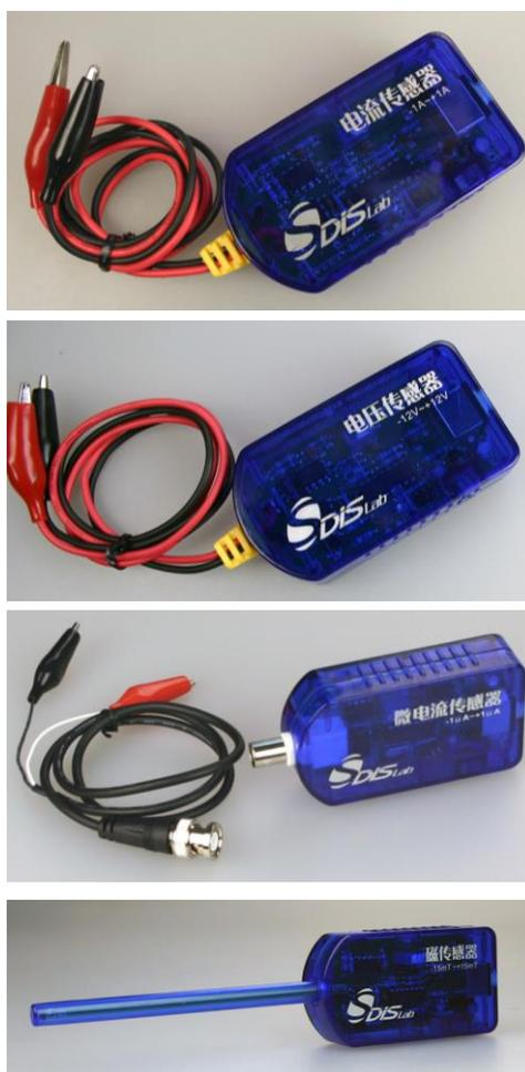
图 51 自上而下，电流、电压、微电流和磁感强度传感器
